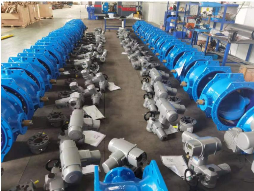
闸阀安装要点：安装位置、高度、进出口方向必须符合设计要求，连接应牢固紧密。安装在保温管道上的各类手动阀门，手柄均不得向下。阀门安装前必须进行外观检查，阀门的铭牌应符合现行国家标准《通用阀门标志》GB 12220的规定。对于工作压力大于1.0 MPa 及在主干管上起到切断作用的阀门，安装前应进行强度和严密性能试验，合格后方准使用。强度试验时，试验压力为公称压力的1.5倍，持续时间不少于5min；阀门壳体、填料应无渗漏为合格。严密性试验时，试验压力为公称压力的1.1倍；试验压力在试验持续的时间应符合GB 50243标准要求，以阀瓣密封面无渗漏为合格。闸截止蝶阀低压下，可以实现良好的密封。安徽电动蝶阀维修厂家
